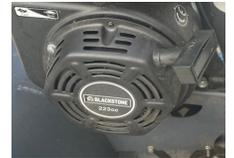
Après quelques minutes de chauffe : replacer le starter en off.
